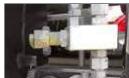
Датчик, ограничивающий движение при нахождении крюка в верхнем положении
