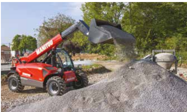
Конфигурация ковша для работ в тяжелых эксплуатационных условиях
