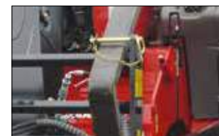
Блокировка вил для транспортировки
