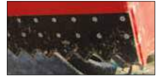
Кромка ковша закреплена болтами - качественный срез и легкое техобслуживание (кроме SHG 1700 / 850 сварные)
