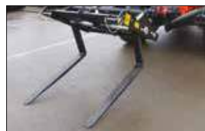
Плавающие вилы с выравниванием
