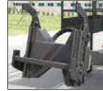
Раскрытие гидравлического захвата от 325 до 482 мм
