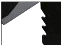
Боковые зубья для захвата грузов цилиндрической формы
